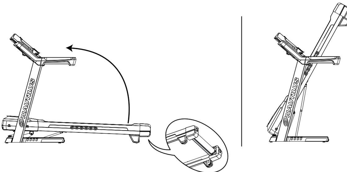
4. Assurez-vous que le mécanisme de verrouillage est engagé. Vérifiez délicatement que la plate-forme la marche ne bouge pas. Maintenez-vous à l'écart de la trajectoire de mouvement au cas où le verrouillage du tapis roulant n'est pas engagé.
