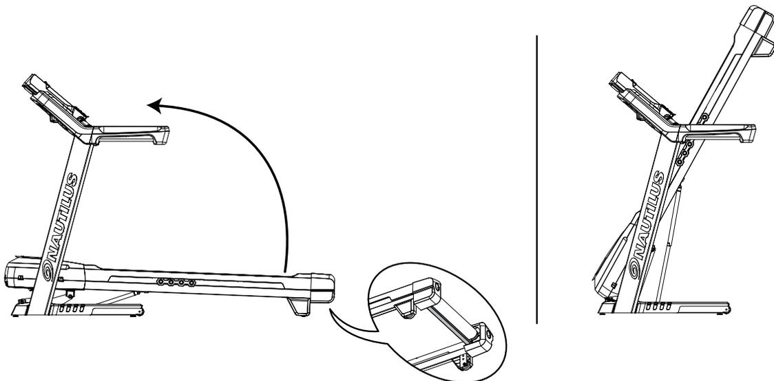
6. Assurez-vous que le mécanisme de verrouillage est engagé. Vérifiez délicatement que la plate-forme de marche ne bouge pas. Maintenez-vous à l'écart de la trajectoire de mouvement au cas où le verrouillage du tapis roulant n'est pas engagé.
