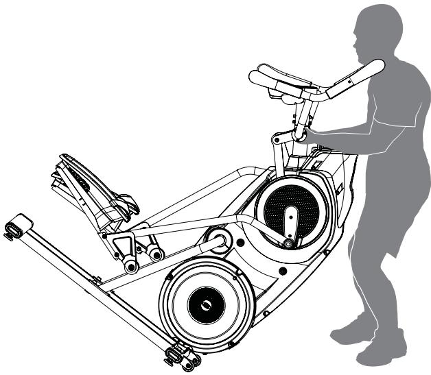
**ПРИМЕЧАНИЕ.** Будьте осторожны при перемещении тренажера. Любые резкие движения могут отрицательно повлиять на работу компьютера.
